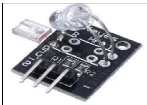
Fig. 3. Heart Rate Sensor (Ky-039)
